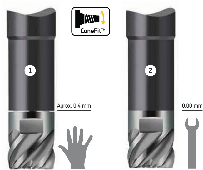
Pares de giro para el montaje de las cabezas de fresado
