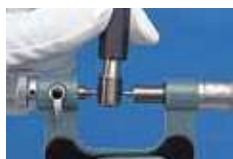
116-101 con tope y punta intercambiable opcional listo para medir
